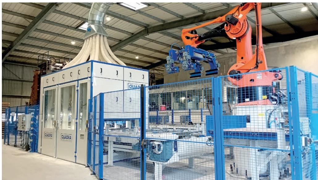
Robot de palettisation en sortie de rectifieuse pour la manipulation des blocs rectifiés.
