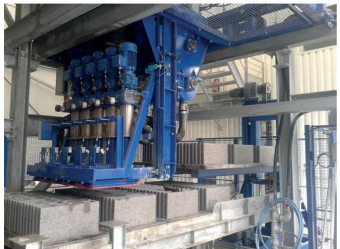
Unité de dosage et de remplissage des alvéoles de blocs avec de l'Air'Mousse
