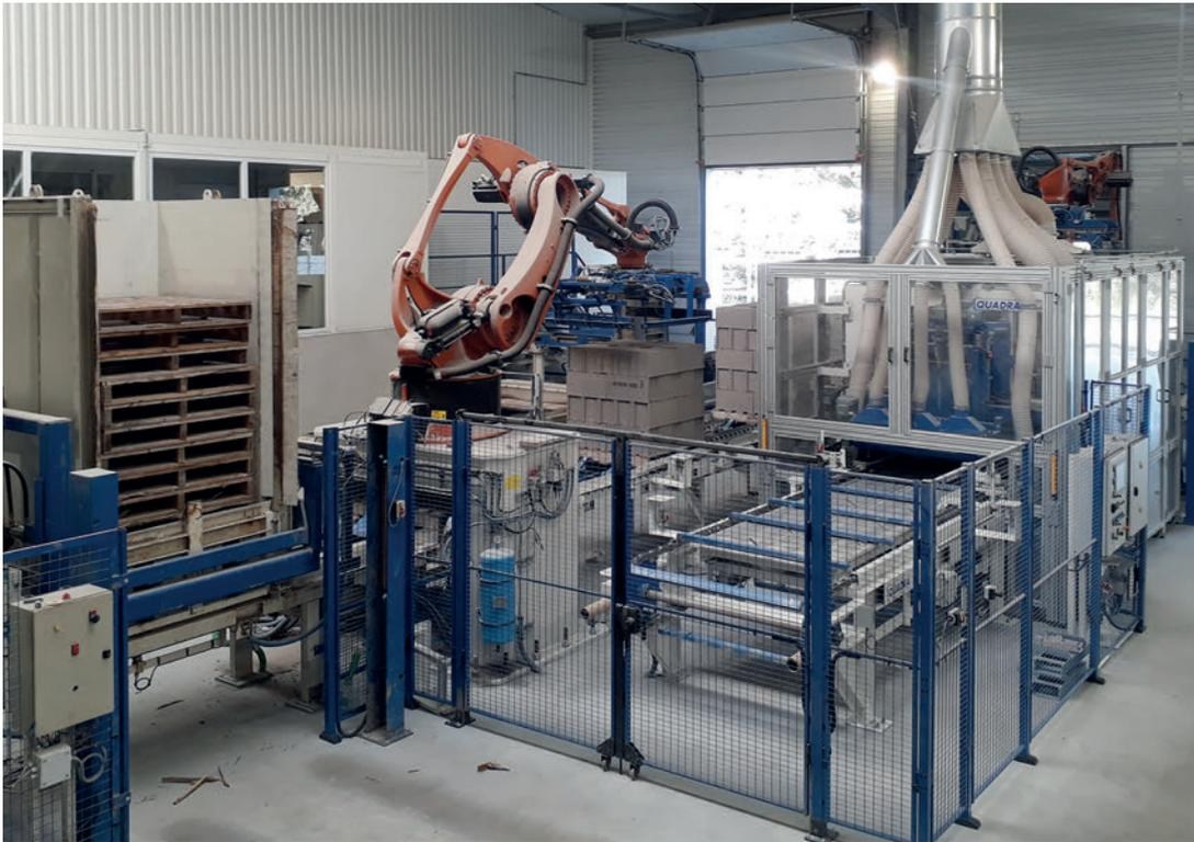
Robots de paletizado Kuka de 4 ejes tipo KR 700 PA
