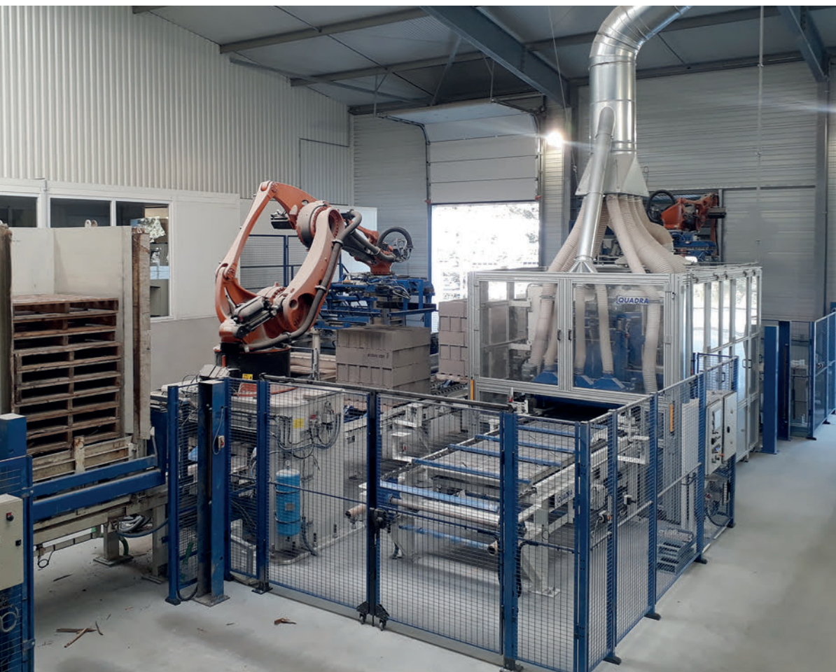
Kuka 4-axis robots type KR 700 PA
