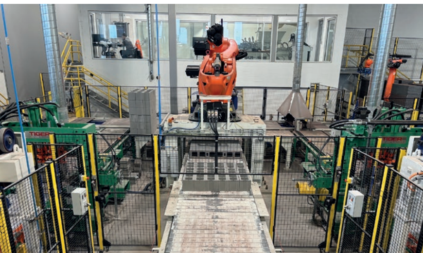
Le 1 er robot alimente les 3 lignes de convoyeurs, soit vers le poste de palettisation, soit vers les deux lignes de splitage
