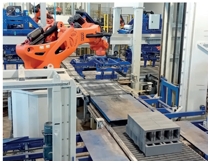
Robot du poste de palettisation
