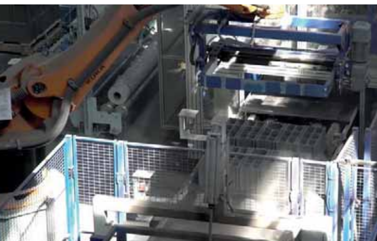
El empaquetado de los productos tiene lugar mediante el robot de cuatro ejes Kuka KR470 PA con una capacidad de carga de 470 kg.
