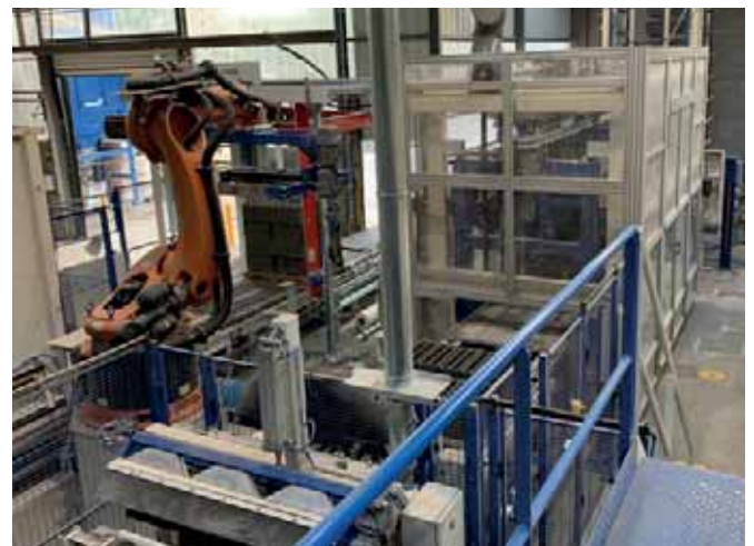
El robot es controlado con un software de control que está integrado en la interfaz de Quadra. Los ajustes de las fórmulas pueden modificarse sencillamente desde el pupitre de mando.
