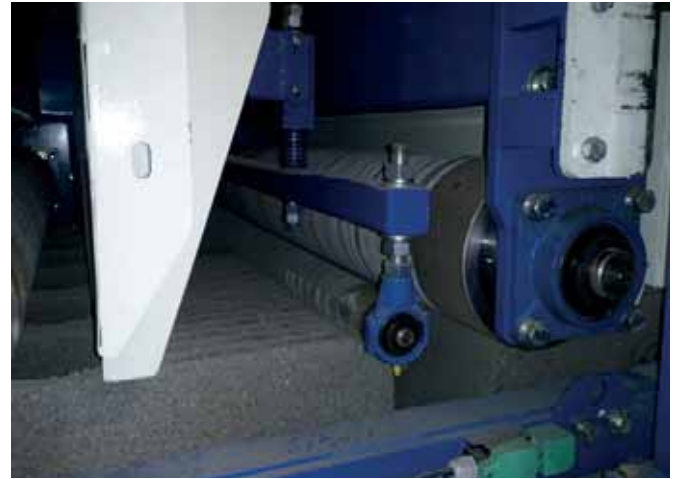
La rectificadora del tipo «rodillos diamantes» fue perfectamente adaptada a la producción de Pomel Beton.
