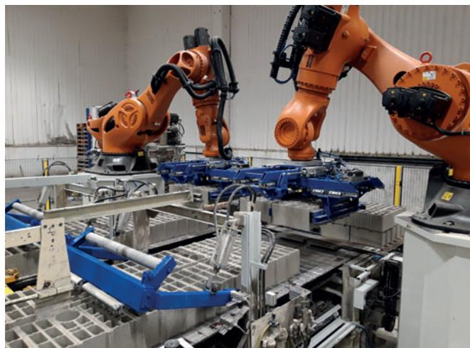
*Cette nouvelle ligne de palettisation comporte 3 robots fonctionnant simultanément, et capables d'accompagner le cycle de la presse dans des conditions de fonctionnement alliant rapidité, précision, souplesse, fiabilité.*
