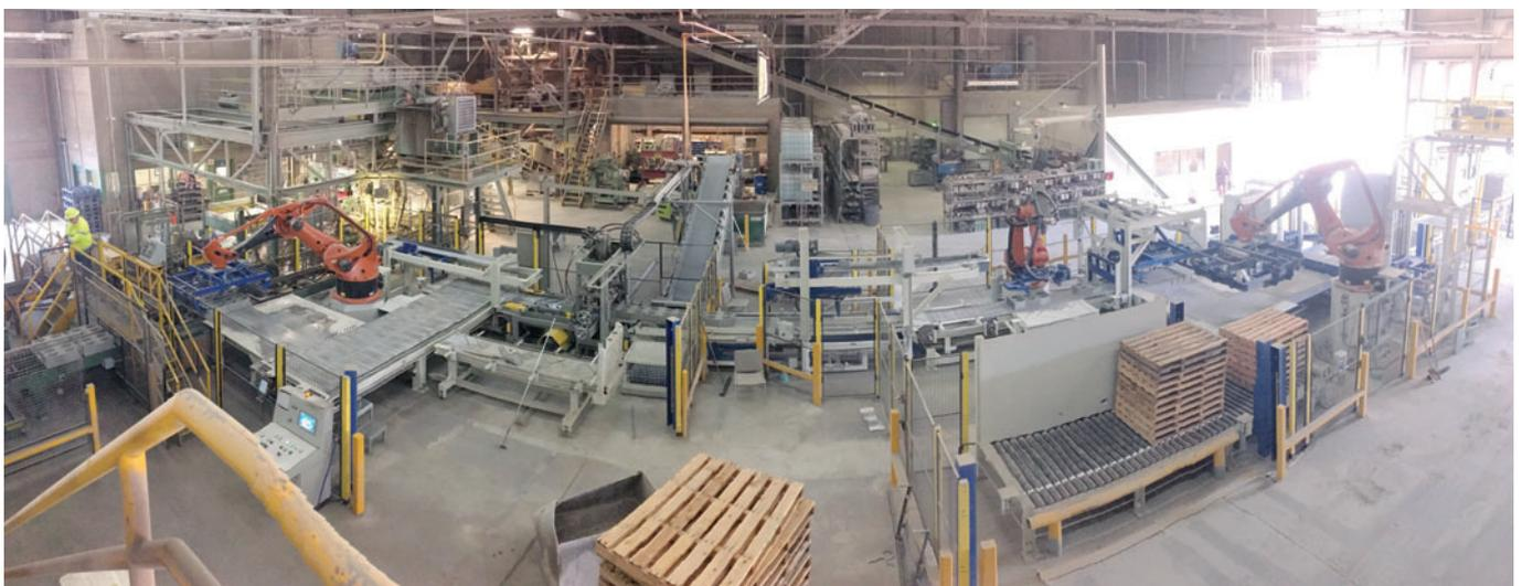
*Nouvelle ligne de palettisation composés de 3 robots Kuka, un ensemble de convoyeurs et un splitter de produits en béton.*
