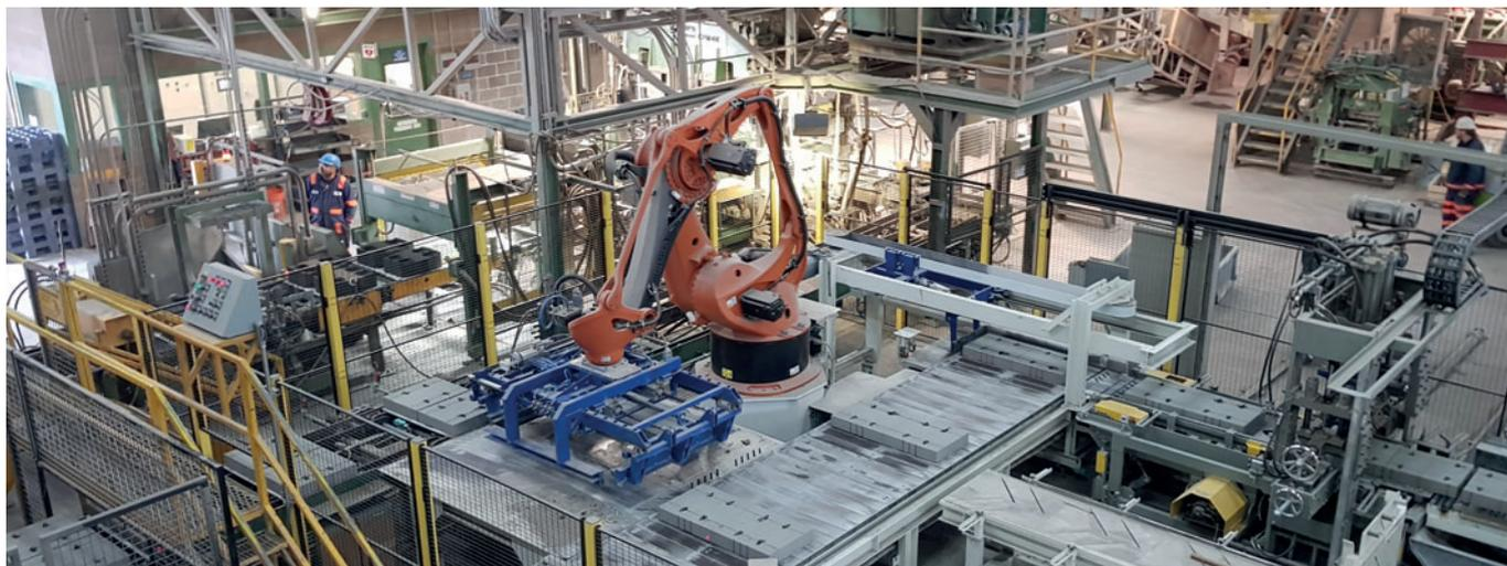
Robot de dépilage de marque Kuka type KR700-4 axes, équipé d'une pince de serrage pneumatique conçue et fabriquée par Quadra
