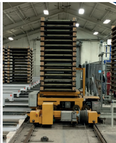
Remplissage et dosage automatique des moules
