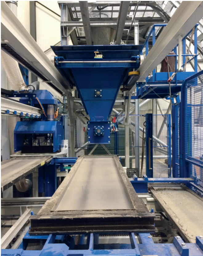
Remplissage et dosage automatique des moules
