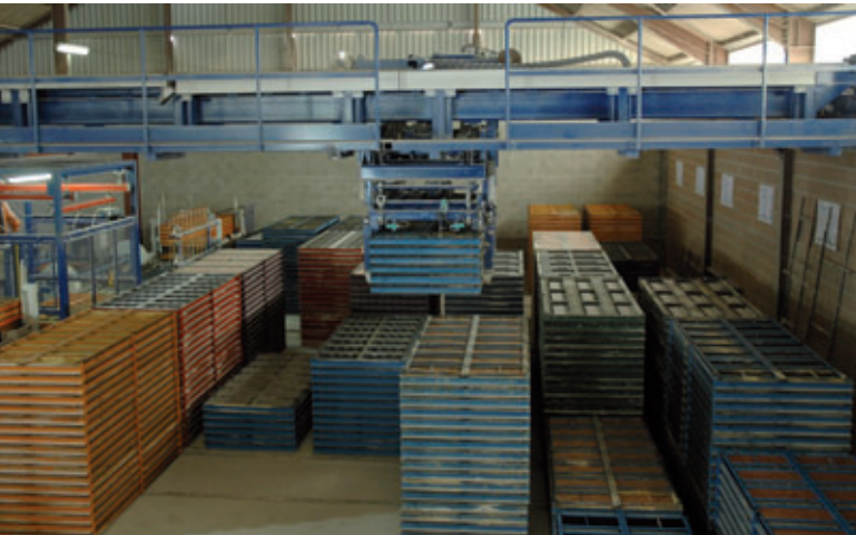
Le pont roulant dispose d'un automate embarqué
