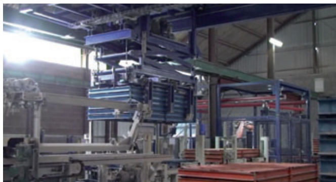
La pince de levage évite toute déformation des plateaux
