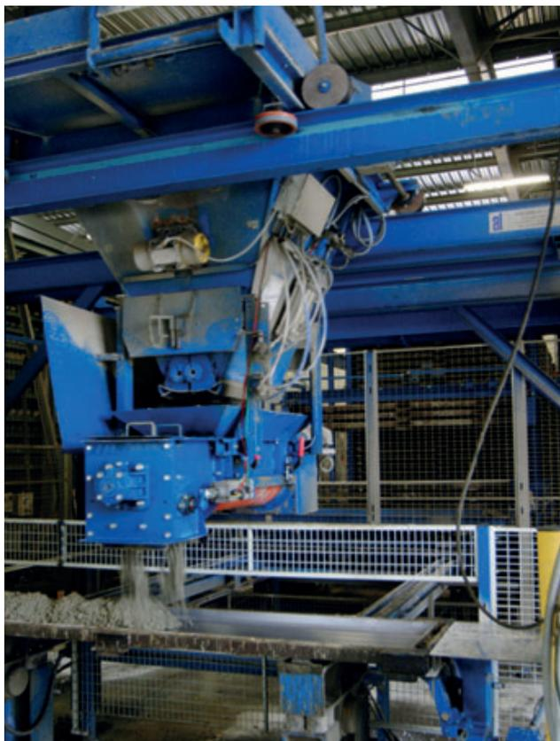
au sol. Le moule subit alors une vibration homogène et « débulée », et l'opérateur peut déposer des armatures métalliques.
