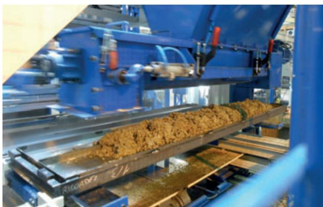
Trémie : remplissage et dosage automatique des moules
