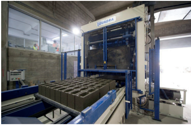
18 blocs sont produits par cycle de fabrication et la tolérance en hauteur est de moins de 1mm sur toute la surface des panneaux de production.
