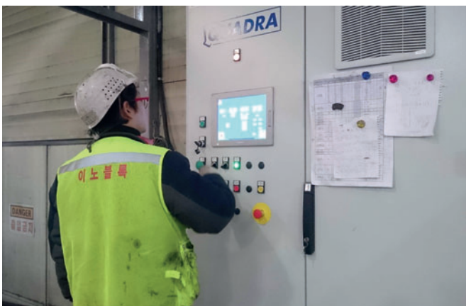
Le programme d'automatisme intégré permet la sauvegarde et le rappel automatique des paramètres de réglage du doseur par type de produits fabriqués
