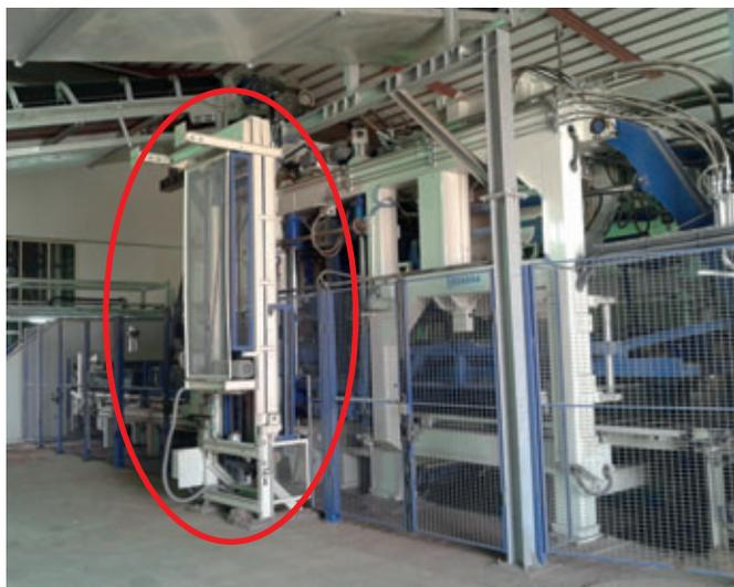
*Introduceur de polystyrene : configuration rationnelle pour une utilisation simple et efficace*
