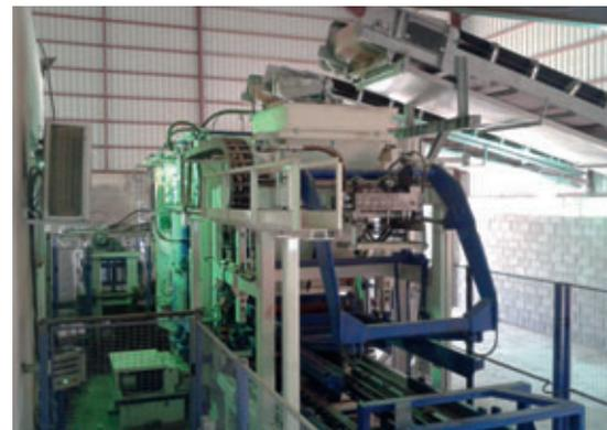
La presse vibrante Q12 HP déploie une cadence industrielle remarquable : entre 13 et 15 secondes pour des pavés bi-couches.
