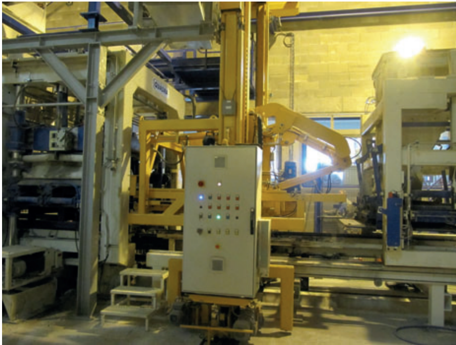
Transstockeur en position de chargement du moule dans la presse
