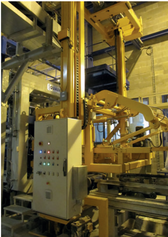
Changement de moule effectué par le transstockeur automatique
