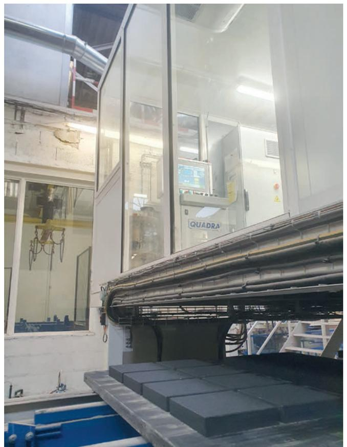
*La instalación está equipada con una cabina de control insonorizada situada en el centro de la línea de producción, en la que el nivel de ruido se reduce a aprox. 65 dB.*
