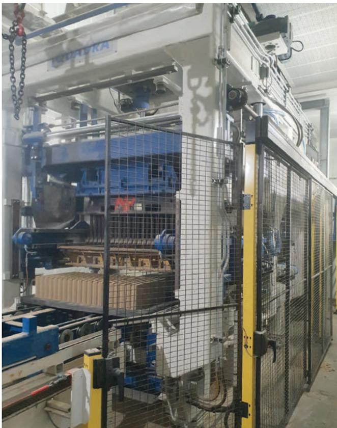
*El potente sistema vibratorio de la máquina bloquera Quadra 6 HP reduce significativamente el tiempo del ciclo.*
