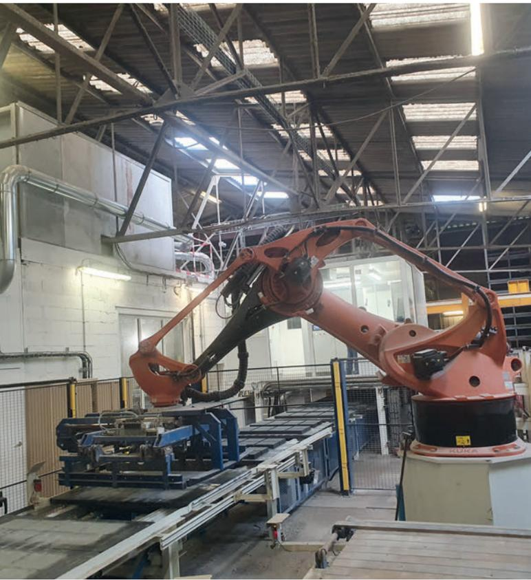
*Se instaló un robot Kuka KR 700 equipado con una pinza de cuatro lados para manipular y seleccionar los productos.*
