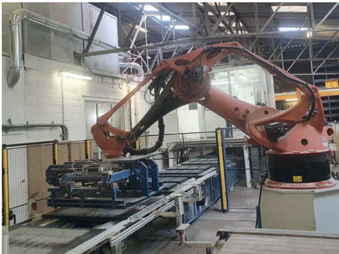
*Un robot Kuka KR 700 équipé d'une pince à 4 faces a été installé pour assurer la manipulation et la sélection des produits.*
