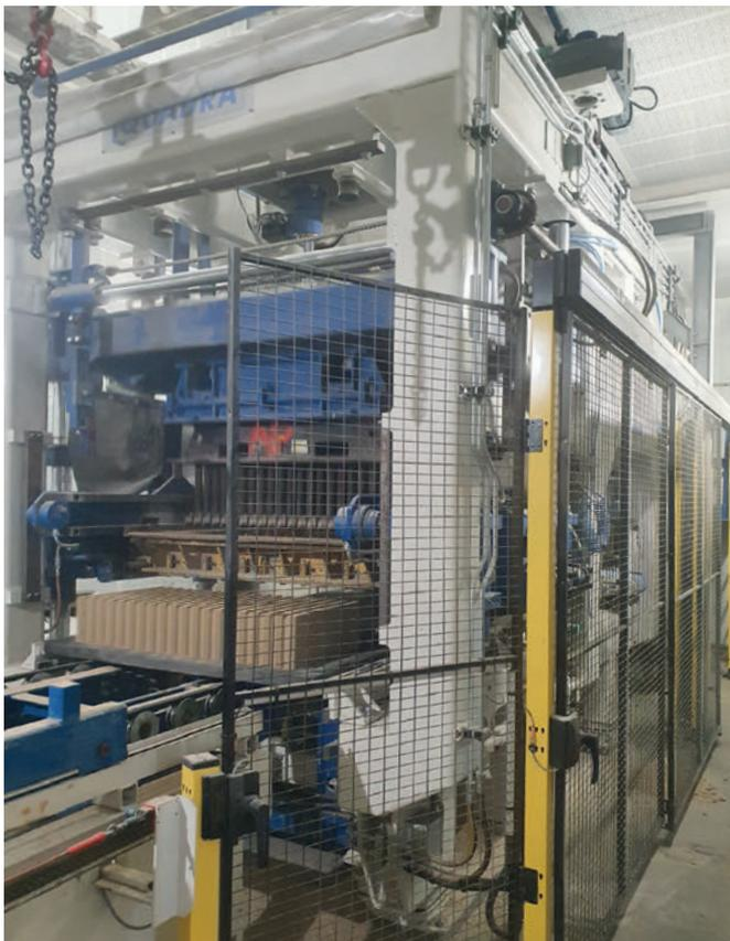
*Le système de vibration haute performance de la machine à blocs Quadra 6 HP permet une réduction significative des temps de cycle de fabrication.*
