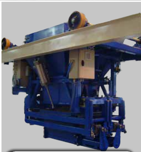
Llenado de los moldes por dosificación automática
