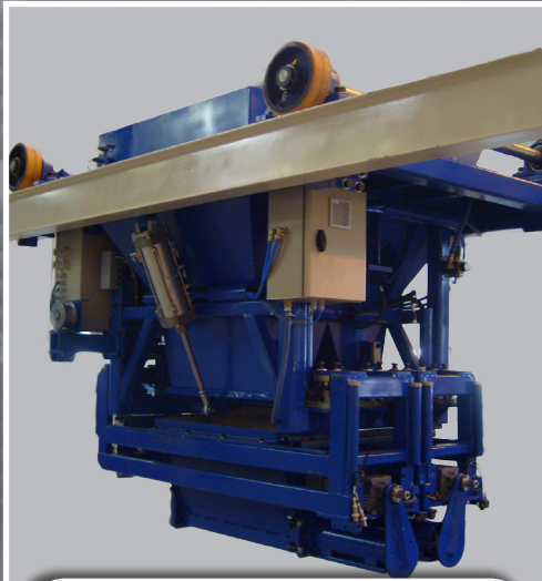
Remplissage des moules par dosage automatique Automatic mold filling system
