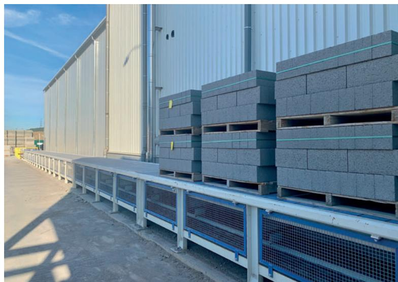
*Transportador para el almacenamiento previo de hasta 90 palets fuera del edificio de producción.*
