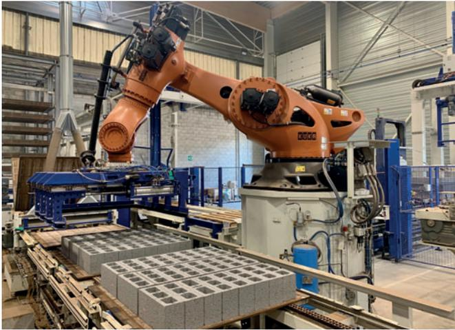
*El robot de paletizado Kuka KR 1000 con 6 ejes presenta una capacidad de carga de hasta 1300 kg.*
