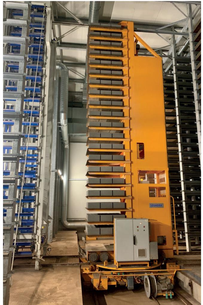
*Un carro multiforca con plataforma giratoria, que transporta las 20 bandejas, realiza los procesos de colocación y extracción. La cámara de curado tiene una capacidad de 4920 bandejas y está equipada con un sistema de ventilación.*
