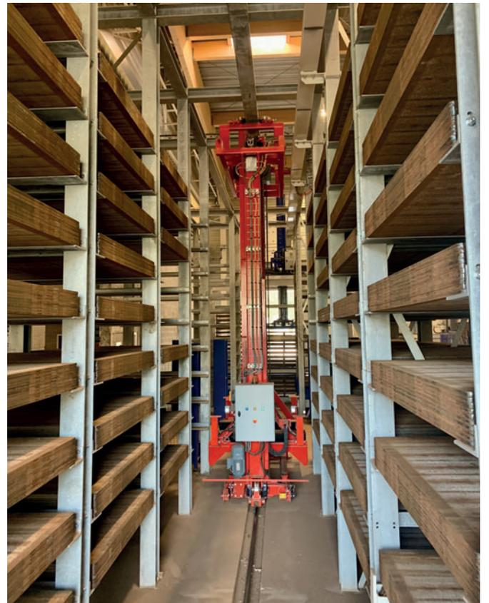
Un almacén con 860 bandejas, gestionado automáticamente por un alimentador de estantes, garantiza el funcionamiento continuo de la unidad de producción.
