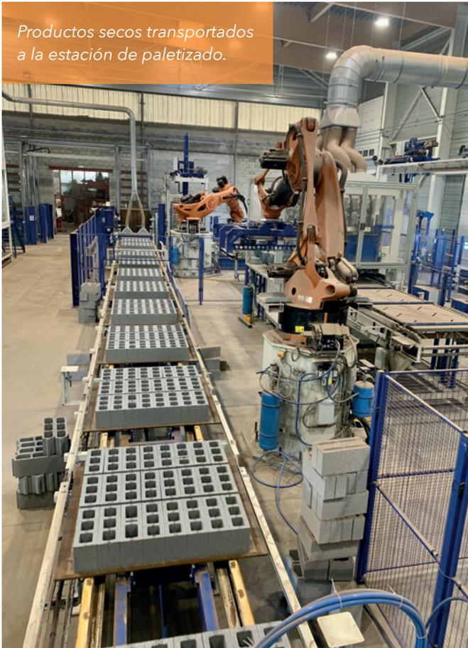
En la fabricación de bloques huecos, cada 13 segundos se disponen 18 bloques con un tamaño de 20/20/40 cm sobre una bandeja.
