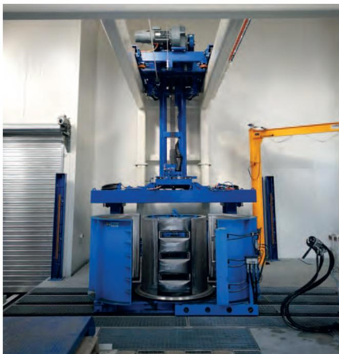
*Pour les opérations de démoulage des rehausses et cônes, le moule étant à ouverture, une connexion hydraulique des moules est actionnée par l'opérateur.*
