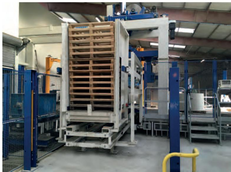
*La ligne de production est alimentée en palette via un magasin à palettes pouvant stocker jusqu'à 20 palettes.*
