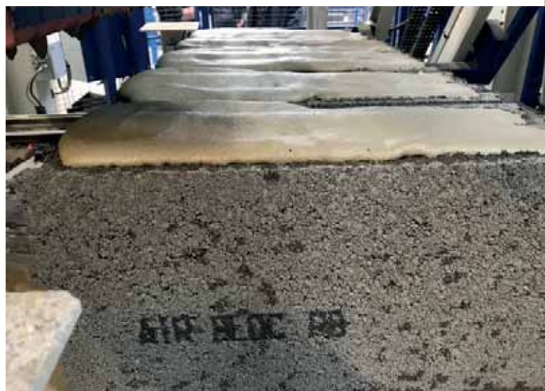
Fabrication du bloc isolant Air'Bloc.
