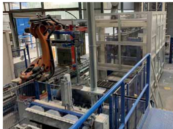
Le robot est accompagné d'un logiciel de commande, et ses paramètres de recettes sont ajustables depuis la cabine de contrôle.
