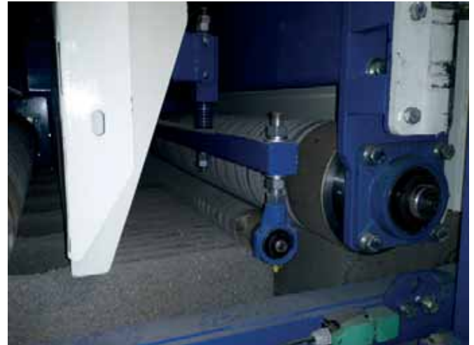
Une rectifieuse type "rouleaux diamantés" était parfaitement adaptée à la production de Pomel Beton.
