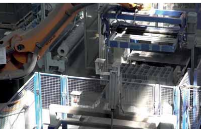
La palettisation des produits est effectuée par un robot KUKA 4 axes type KR 470 PA dont la capacité de charge est de 470 kg.
