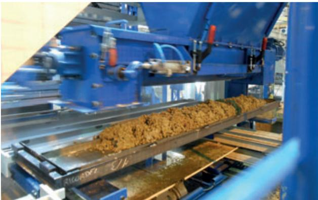
Alimentación de hormigón: dosificación y llenado automáticos del encofrado
