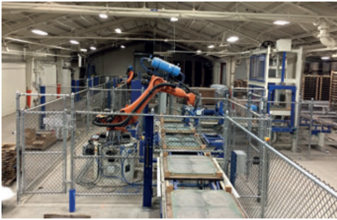
Línea de desencofrado
