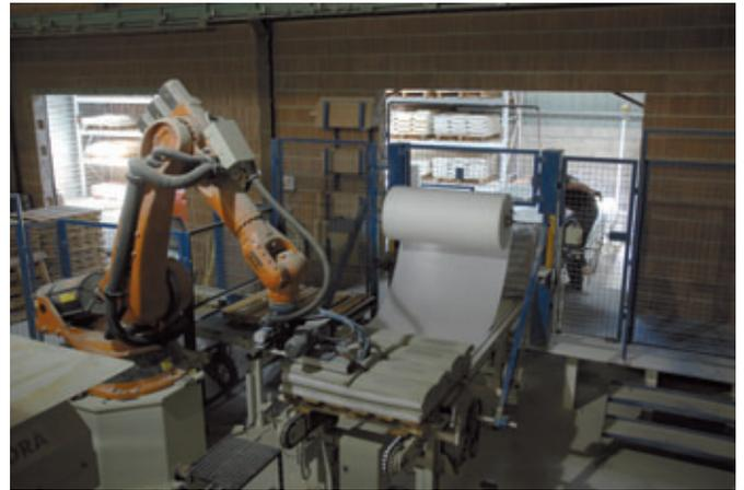
El robot de brazo basculante de 6 ejes coloca los productos en paletas con una pinza al vacío
