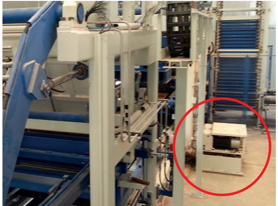
A motorização da unidade de vibração no lado da máquina de blocos de concreto
