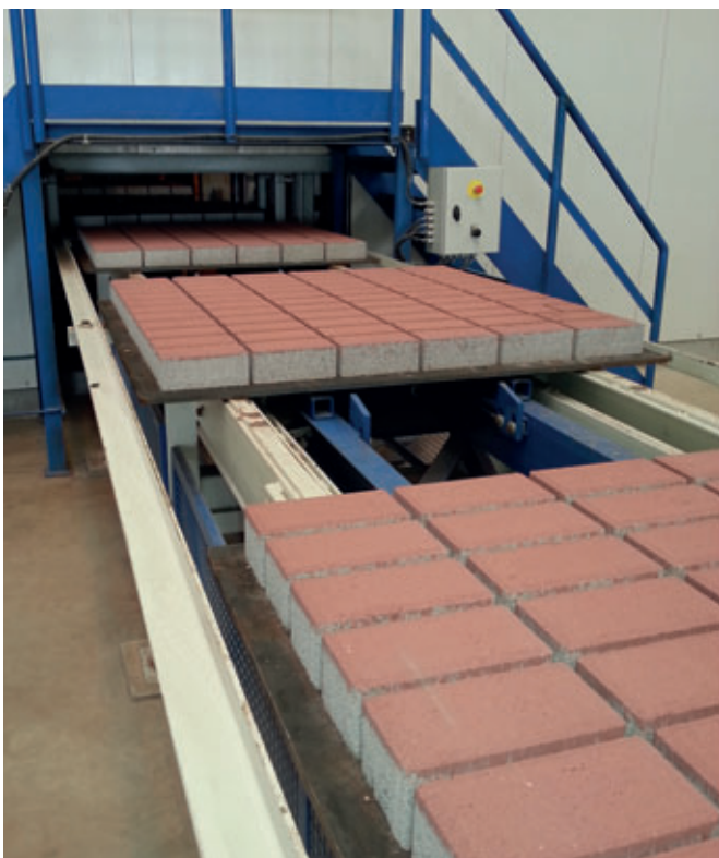
Os produtos acabados são transferidos para o formador de cubos mediante um elevador de transporte.
