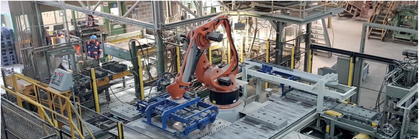
Robot despalletizador de cuatro ejes Kuka KR 700 con la pinza neumática desarrollada y fabricada por Quadra
