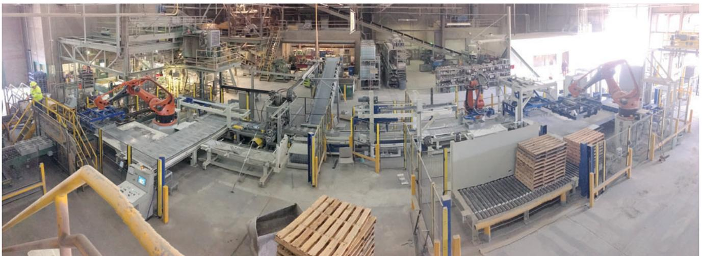
Línea de embalaje completamente nueva con tres robots, sistema de transporte y esplitadora
