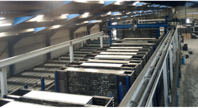
Almacenamiento con grúa corredera
