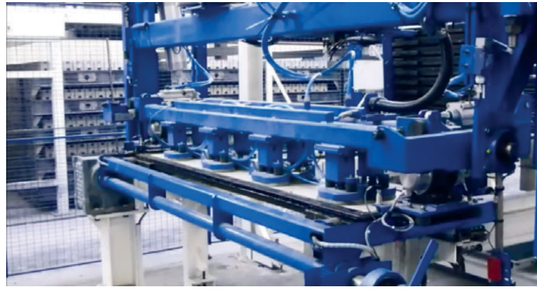
Proceso de desencofrado
