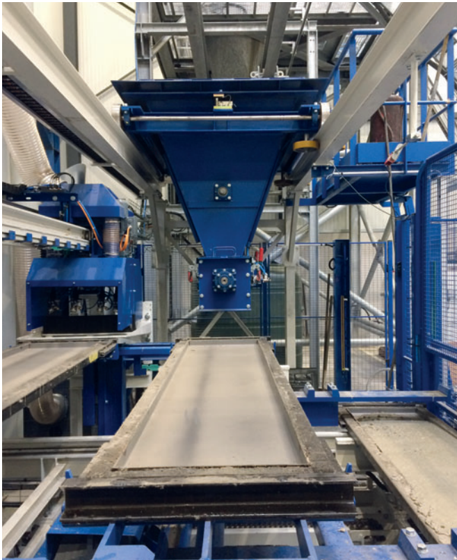
Sistema automático de llenado de moldes y dosificación
