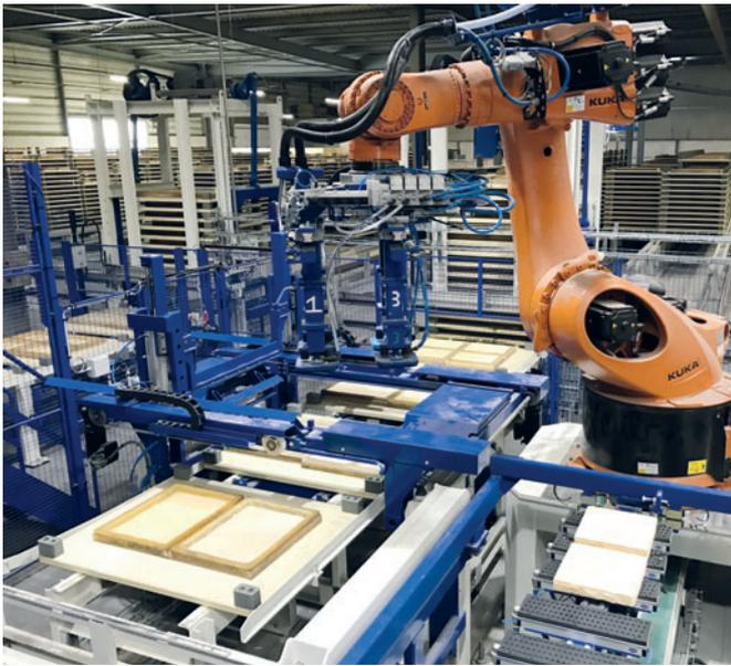
El proceso de desmoldeo tiene lugar con un robot de 6 ejes del tipo Kuka KR360, que permite el desmoldeo de productos con un peso de hasta 120 kg
