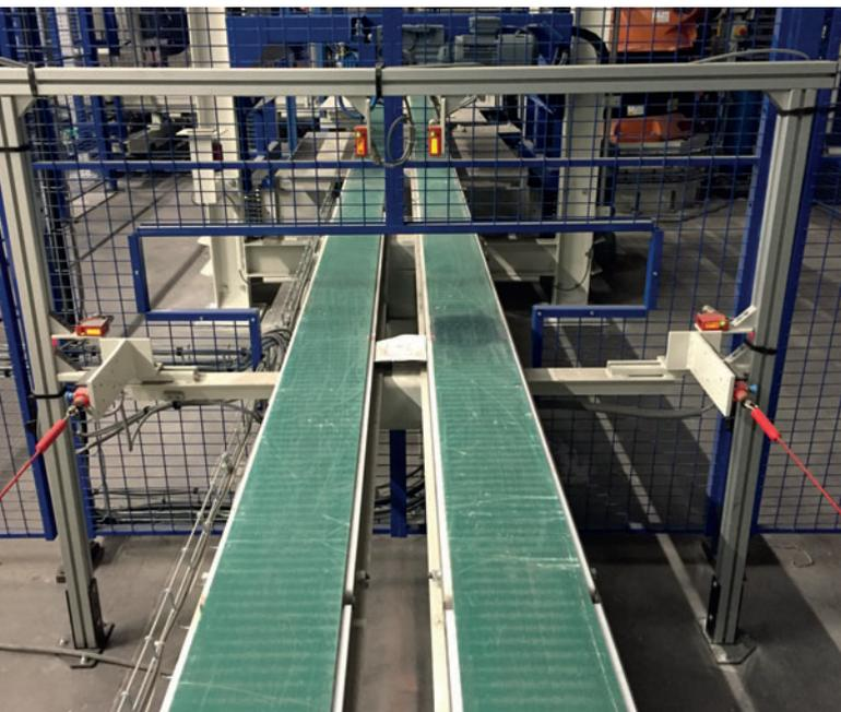
*El sistema de paletización está equipado con un sistema de medición que dispone de láser y sensores: vista de la estación de control de calidad*
