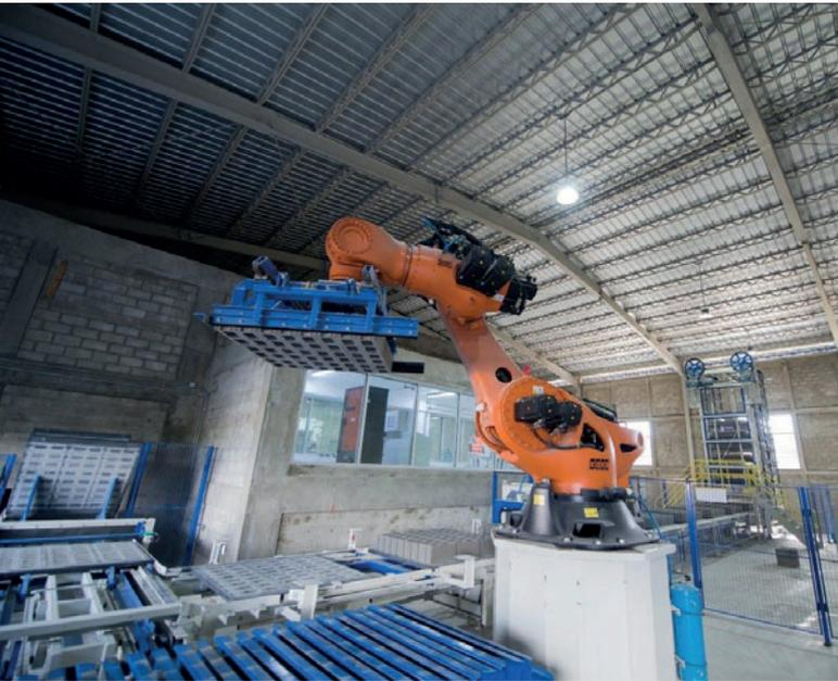
*Robot de paletizado moderno de 6 ejes, carga útil 1300 kg. Este robot puede paletizar bloques huecos sin paletas de madera.*
