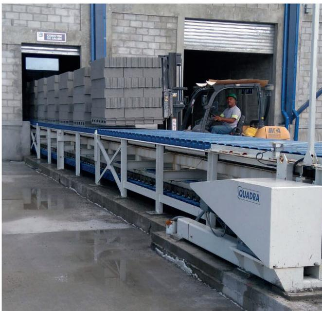
*Una carretilla elevadora recoge los productos de hormigón paletizados de la cinta transportadora*
