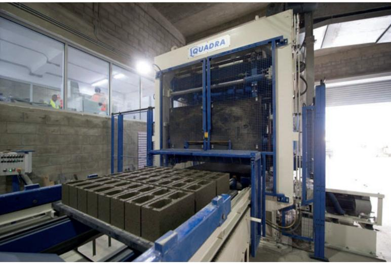
*Por cada bandeja se producen 18 bloques con una diferencia de altura inferior a 1 mm en toda la superficie de la bandeja.*
