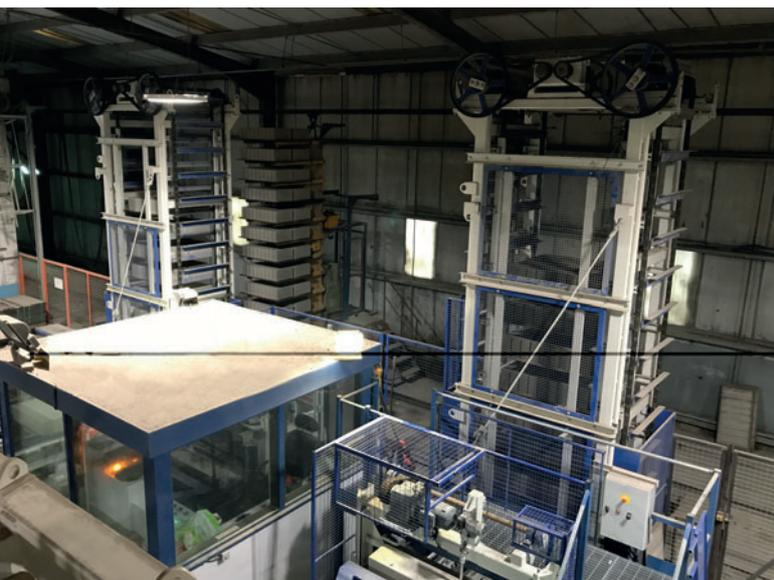
La línea de fabricación está equipada con una cabina de control aislada acústicamente dispuesta en el centro, desde la cual el operador puede controlar la máquina de producción de bloques y supervisar toda la instalación, desde la producción hasta el empaquetado.
