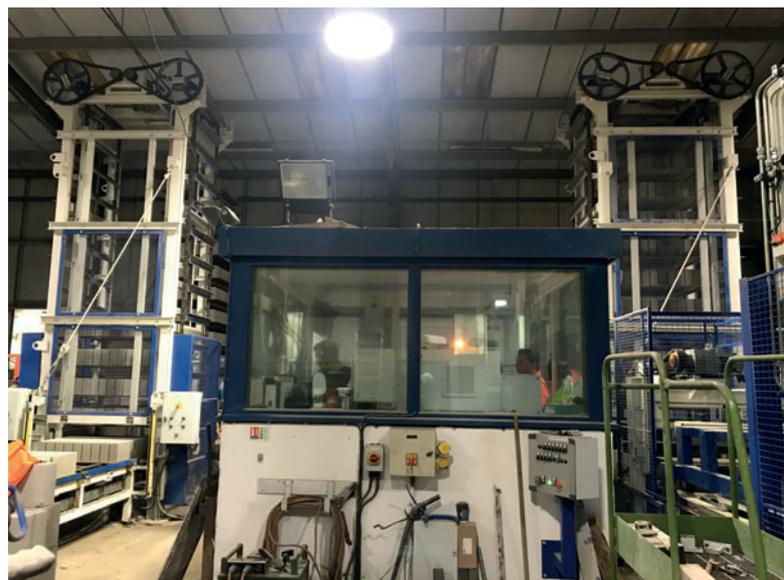
Gracias a esta configuración, el operador puede controlar la máquina de producción de bloques y simultáneamente supervisar toda la línea de fabricación, desde la producción hasta el empaquetado, dando las instrucciones a través de un PLC equipado con una interfaz de usuario.
