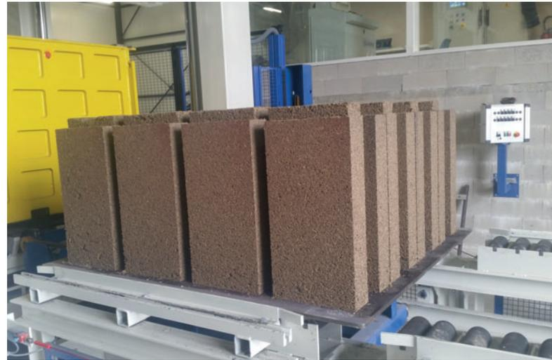
Máquina de producción de bloques a medida, diseñada para la producción de bloques de cáñamo de 300 x 600 x 300 mm.
