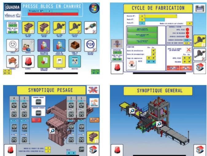
En una pantalla táctil se pueden realizar los ajustes y visualizar todos los parámetros. Con una interfaz clara, intuitiva y sencilla se pueden realizar fácilmente las modificaciones de los ajustes de la máquina de producción de bloques, sin interrumpir la producción.
