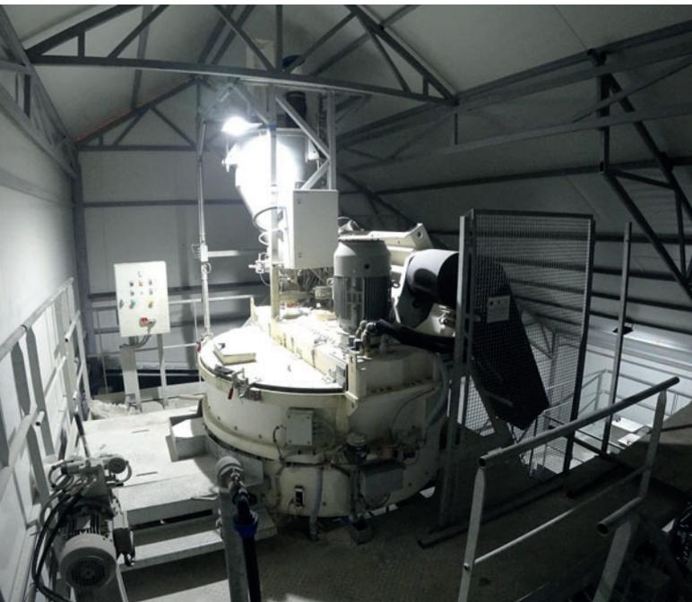
Plataforma de mezcladora cubierta
