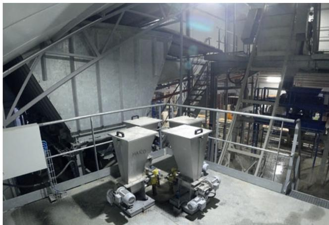
*Los silos de los áridos están compuestos por cuatro contenedores diferentes y disponen de un volumen total de almacenamiento de 60 m<sup>3</sup>. El pesaje de los áridos tiene lugar con una cinta pesadora instalada debajo de los contenedores.*
