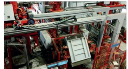
Fig. 5: Grúa de pórtico para desplazar las paletas de desencofrado
