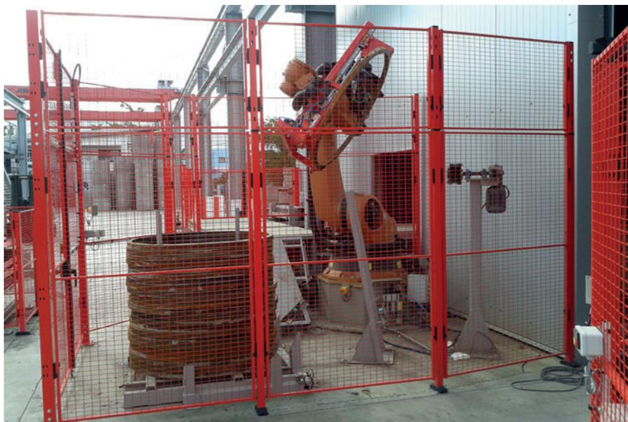
Fig. 9: Robot de limpieza de seis ejes
