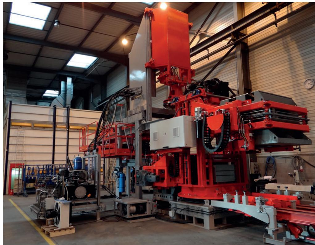
Fig. 3: Prensa vibratoria con desencofrado inmediato
