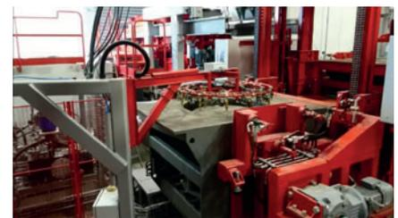
Fig. 4: Alojamiento automático del perfil de secado
