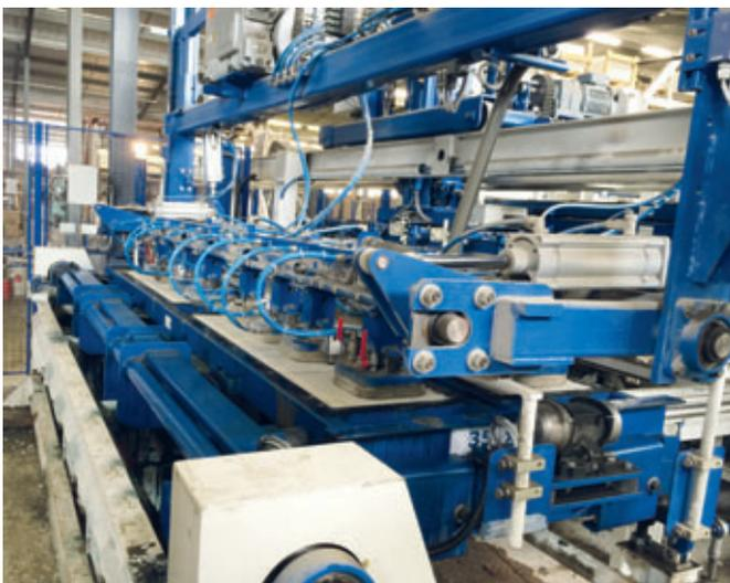
*Estación de desmoldeo y paletización*
