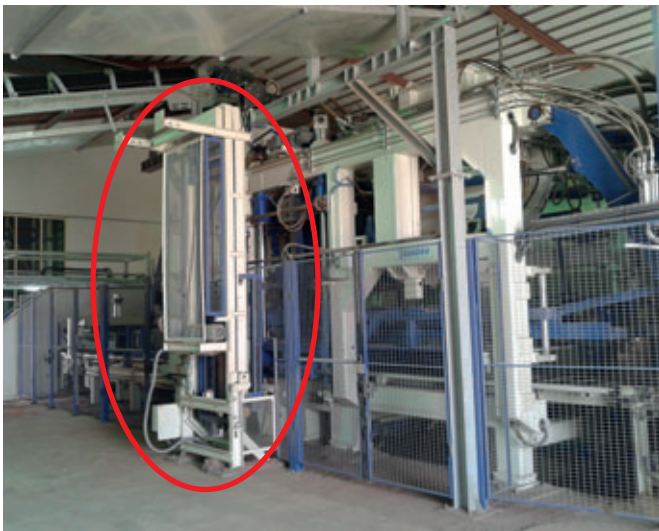
Dispositivo de colocación de aislamiento de poliestireno: configuración esbelta para un funcionamiento sencillo y cómodo.
