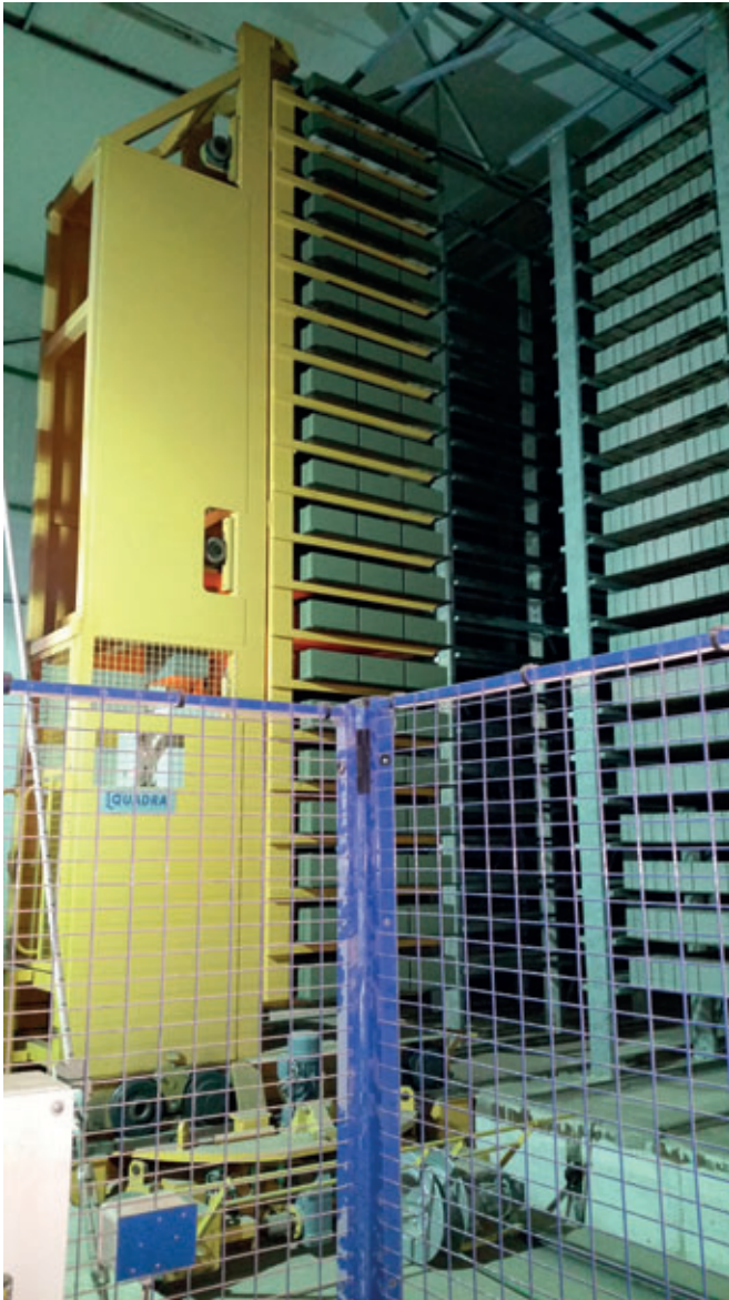
El carro multiforca con plataforma giratoria es utilizado para almacenar los productos de hormigón.
