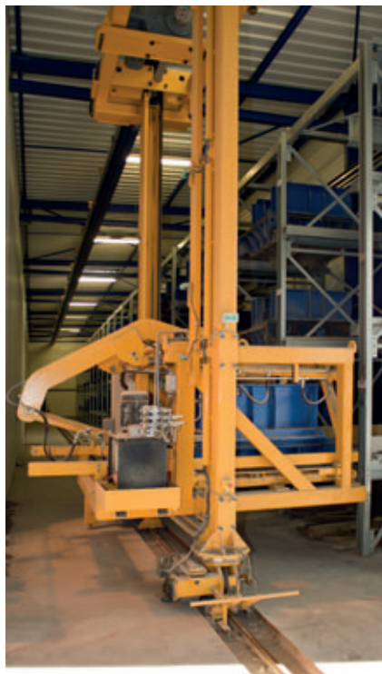
Almacenamiento automático de los moldes en estanterías
