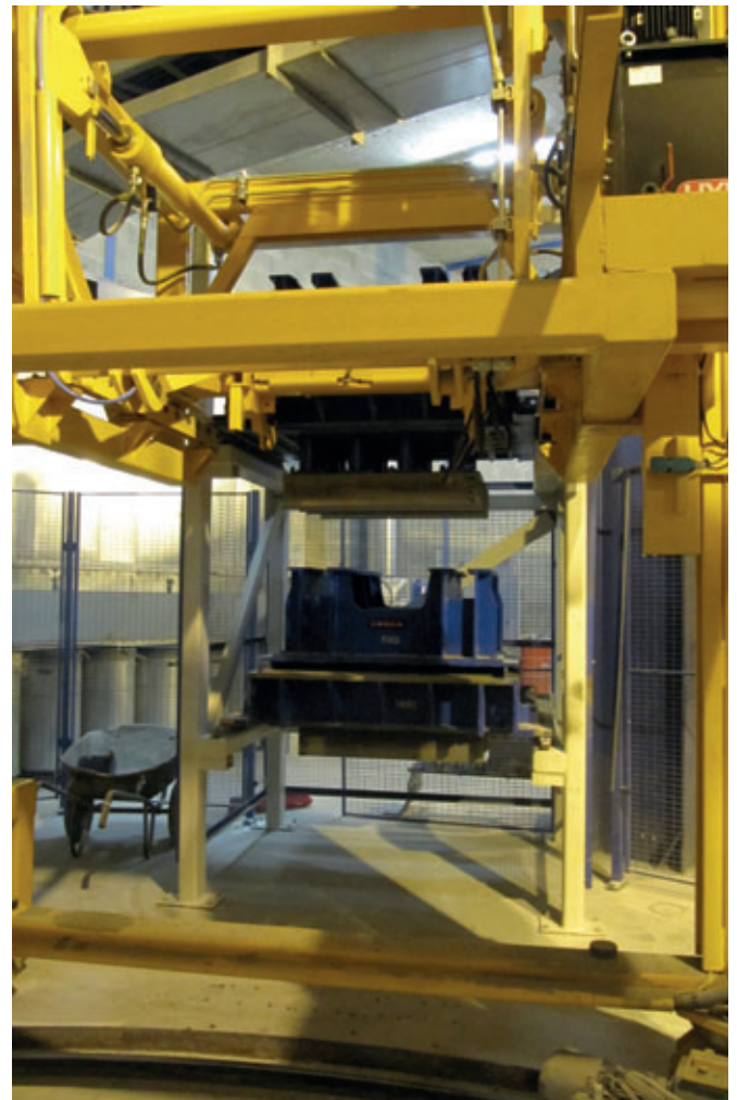
Molde nuevo y molde cambiado en la estantería temporal
