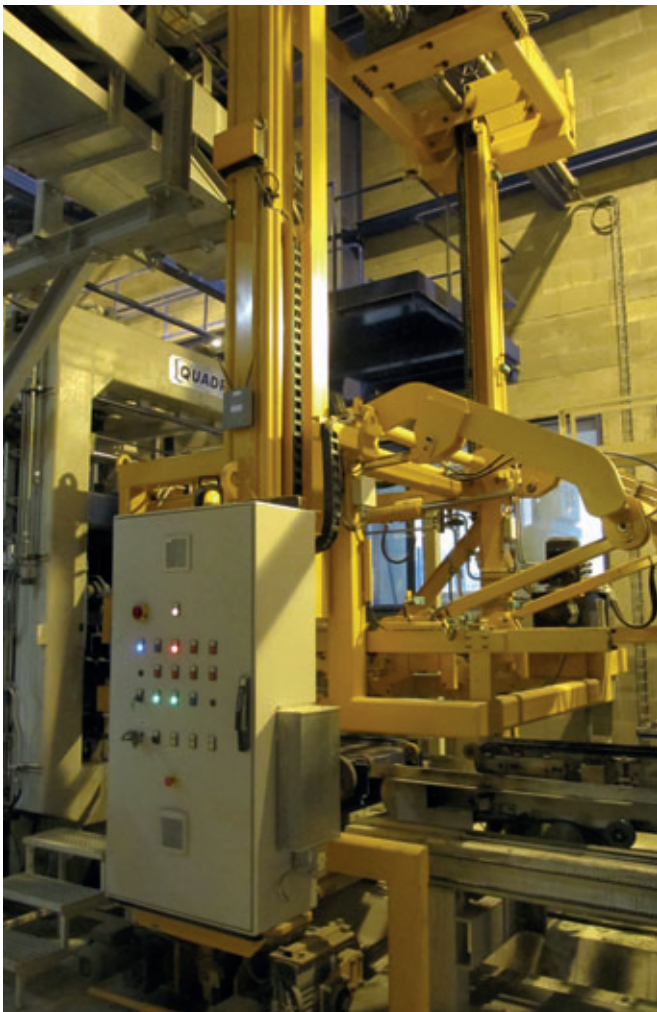
Proceso de cambio de molde
