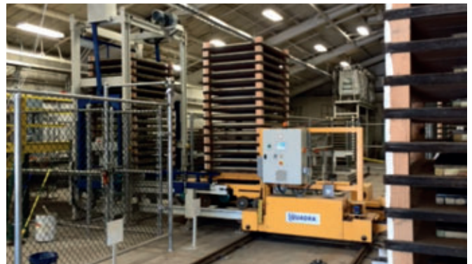
Les piles de moules sont manutentionnées par chariot automatique
