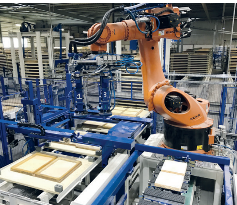
L'opération de démoulage est effectuée par un robot type Kuka KR360 6 axes permettant de démouler des produits pouvant atteindre jusqu'à 120kg.
