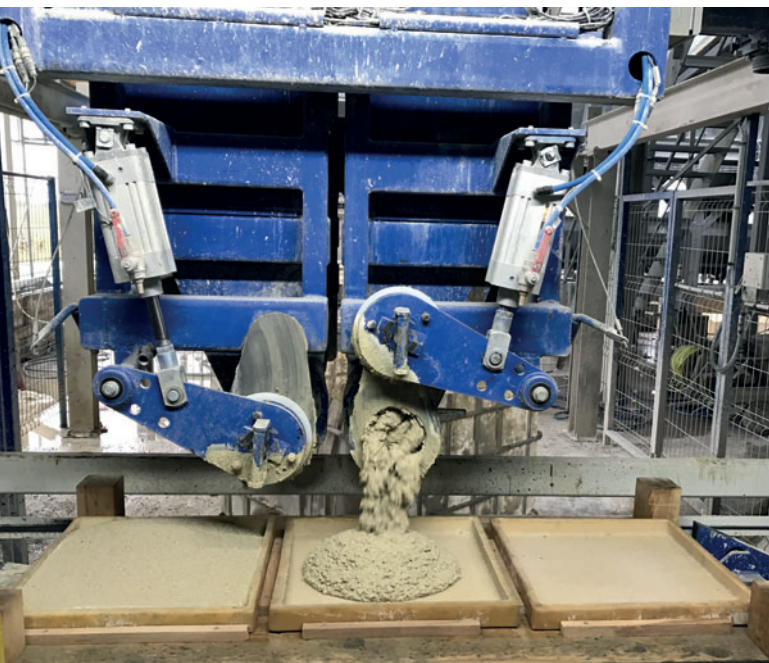
Dosage et remplissage automatique des moules : qualité, précision, propreté, polyvalence et flexibilité
