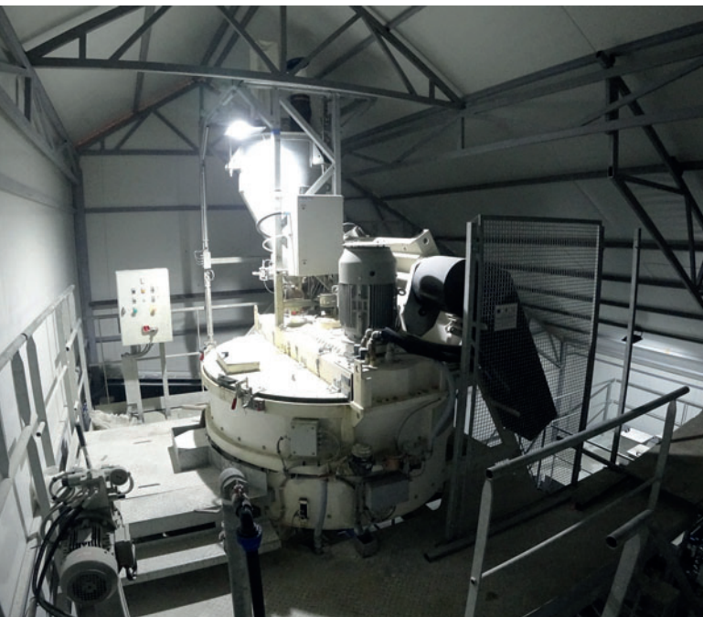
Malaxeur planétaire de marque OMG équipé des dernières technologies micro-ondes.
